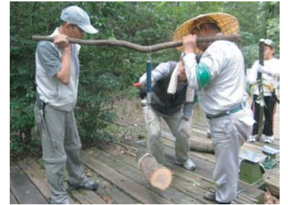
▲切り倒したコナラを玉切りにしてバネばかりで重量を計測
