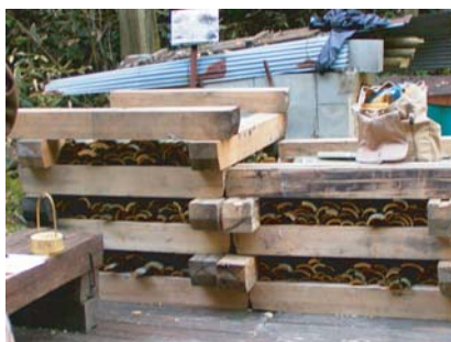
▲竹炭材として一定寸法に切りそろえ、メープル材を使って積み上げる。
